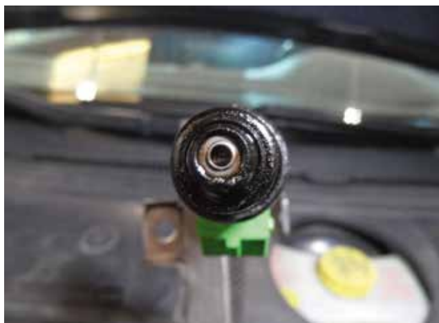
Een natte neus en veel lakafzetting rondom de injector verstoren het sproeibeeld.
